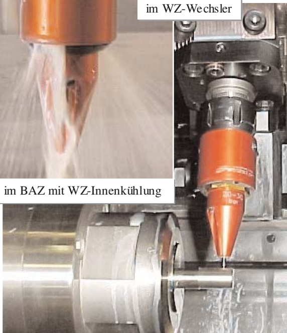
Beschriftung der Mantelfläche auf Drehautomat
