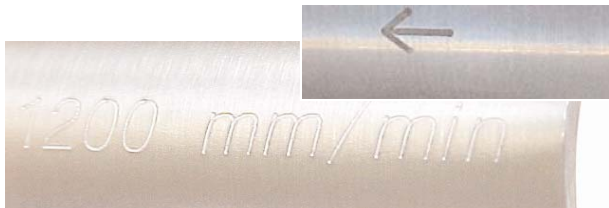
CrNi-Stahl, Radiusbeschriftung ohne Höhenkorrektur
